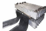
Dịch vụ dán băng tải cao su Service of rubber conveyor belt splicing
